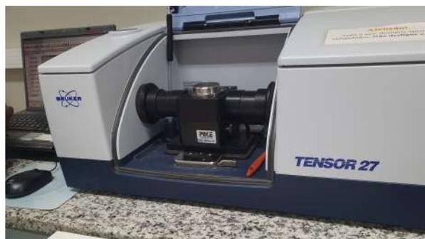
Figure 4.4: FT-IR Spectrometer Bruker Optik GmbH Tensor 27.
