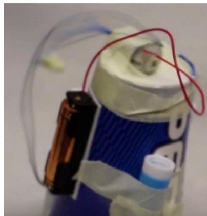
*Figura 55 Colocación de porta pilas en el vaso y conexión de cables*
