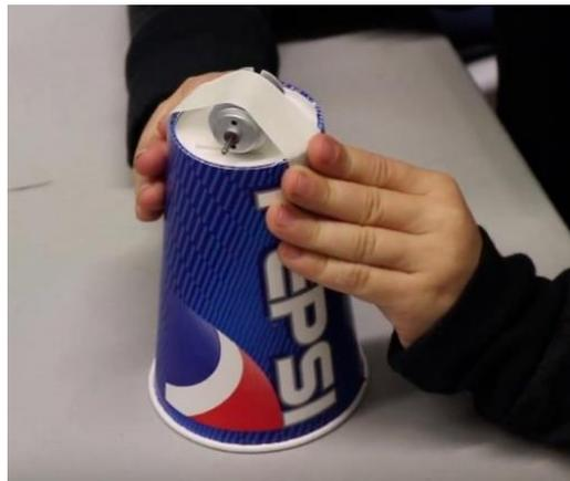
*Figura 54 Colocación de motor en parte inferior del vaso.*
